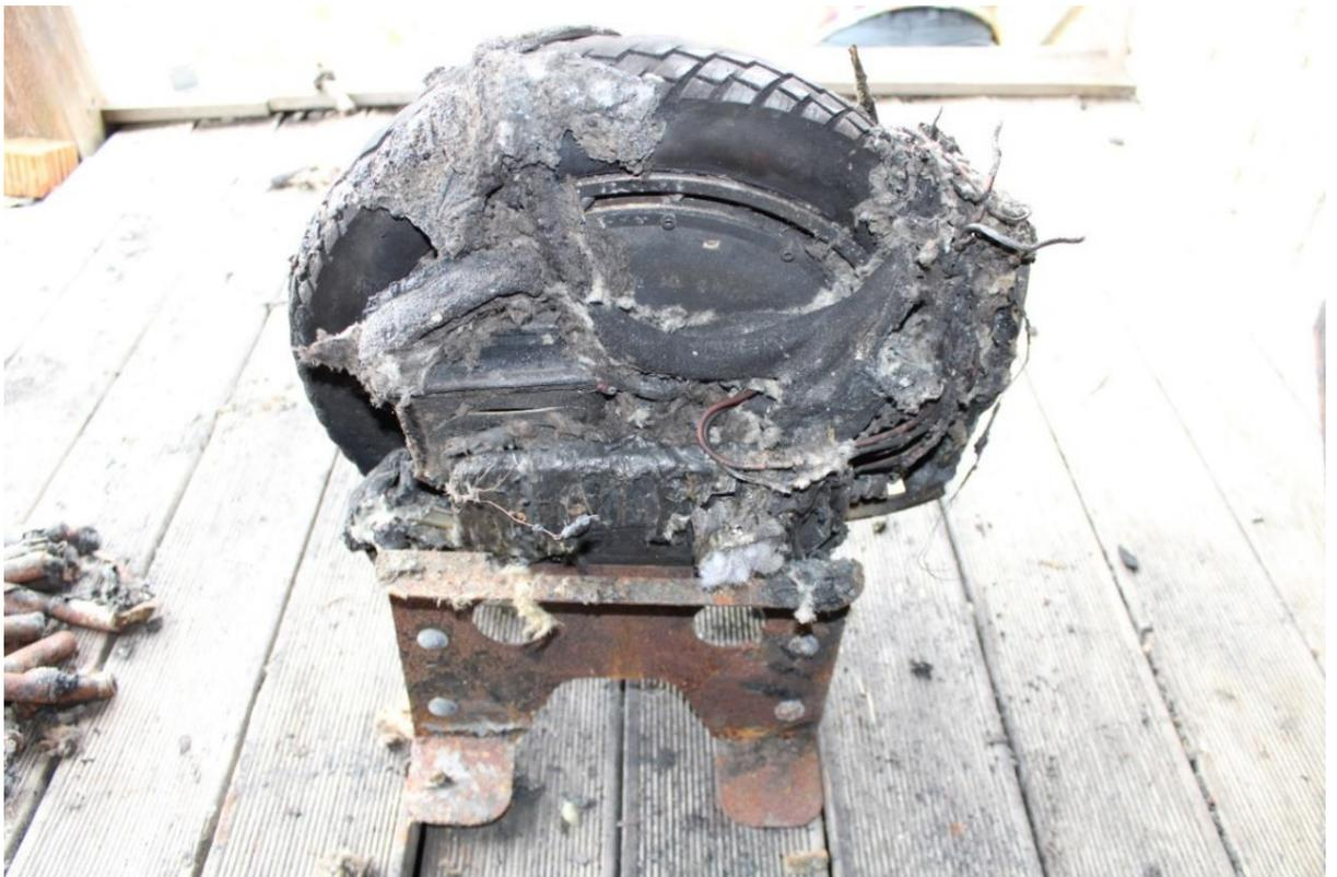
Рис. 5. Деформированное в результате пожара моноколесо
