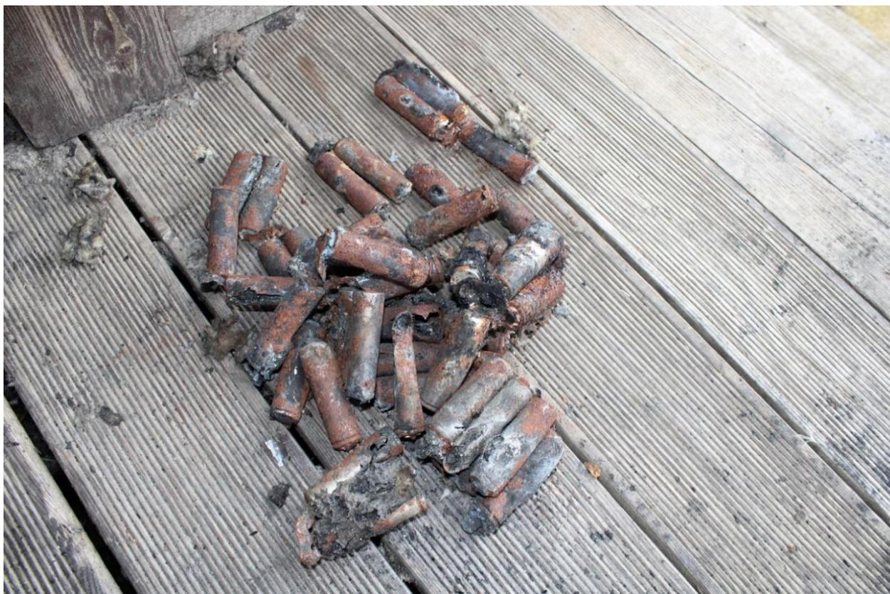
Рис. 6. Отдельные элементы аккумуляторного блока моноколеса
